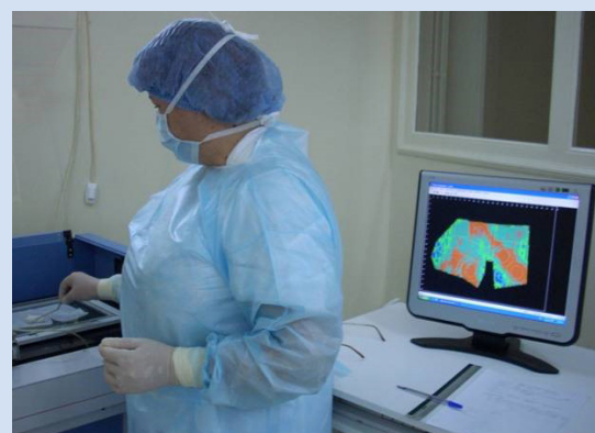
Установка для лазерного раскроя ксеноперикарда Laser cutting system for cutting xenopericardium
