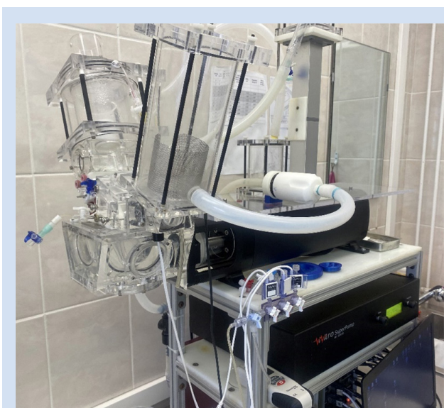
Рисунок 1. Гидродинамический стенд Pulse Duplicator II (ViVitro Labs, Канада)
