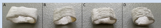
Рисунок 5. Образцы сосудистых протезов после проколов: A – без проколов; B – 8 проколов; C – 16 проколов; D – 24 прокола
