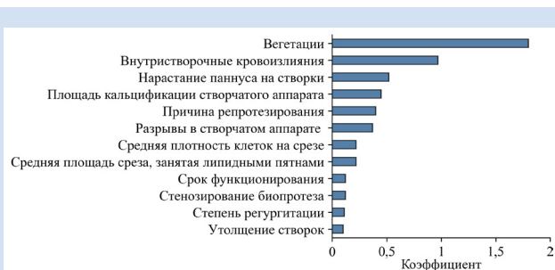
Рисунок 9. Коэффициенты суррогатной модели классификации на основе линейной логистической регрессии
