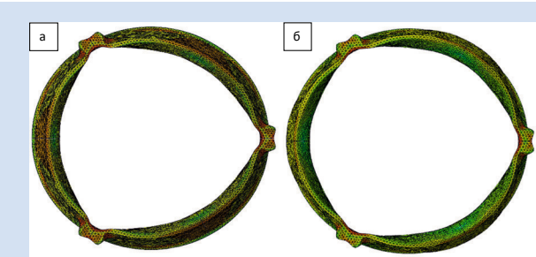
Рисунок 3. Максимальное раскрытие створчатого аппарата при приложении 120 мм рт. ст. в случае различных вариантов геометрии створчатого аппарата
